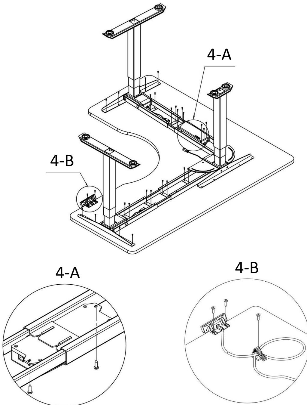
Schließen Sie alle Netzteile an und ziehen Sie dann die Schrauben am Rahmen fest. (Schrauben: 3Stk ST4x16, 3Stk Kabelhalterung)
